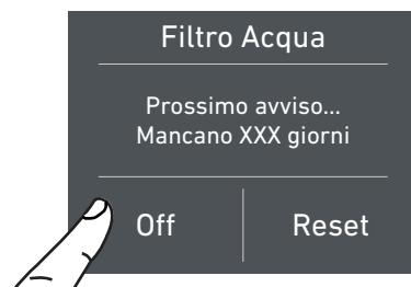
**C)** Premere off per attivare l'avviso di scadenza del filtro acqua.
