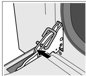
3. Levez légèrement la partie inférieure de la vitre intérieure, jusqu'à ce que les tiges de fixation sortent de la fixation (1).
